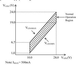
Figure 2. V<sub>VPS</sub> vs. V<sub>LDA</sub>
