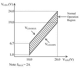
Figure 2. V<sub>VPS</sub> vs. V<sub>LDA</sub>
