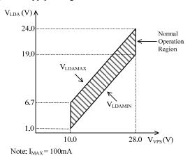
Figure 2. V<sub>VPS</sub> vs. V<sub>LDA</sub>
